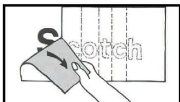
7. Vorhandene Blasen und Luftpinschlüsse mit dem 3M Blasenkiller aufstechen. Die Luft mit dem 3M Raket herausstossen.
