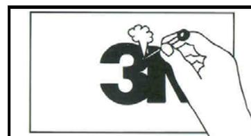
8. Bei Schweissnähten und Materialstößen muss die verklebte Grafik mit der 3M Nietenbürste und dem Fön nachbehandelt werden, um den vollständigen Kontakt der Folie mit dem Untergrund zu erreichen. Die Folie wird an Stößen mit gleichen und unterschiedlichen Materialien an diesen Stellen aufgeschnitten, damit sich durch ein Bewegen des Untergrundes die Folie nicht lösen kann.
