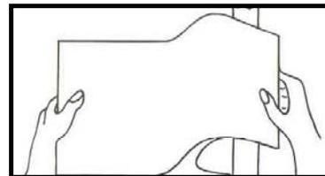
5. Für die Verklebung die einzelnen Folienstücke zurückklappen und ohne Kontakt mit dem Untergrund flach gespannt halten. Nun von der Mitte aus, beim Scharnier beginnend, die Grafik mit dem 3M Raket oder dem 3M Handroller kräftig andrücken.
