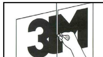
9. Bei Sujets, die aus mehreren Bahnen gefertigt werden, beträgt die Folienüberlappung 3-12 mm. Die Folienränder der vorab geklebten Bahn mit dem 3M Untergrundreiniger S-151 reinigen. Bei der Applikationsreihenfolge stets das Dachziegelprinzip einhalten.
